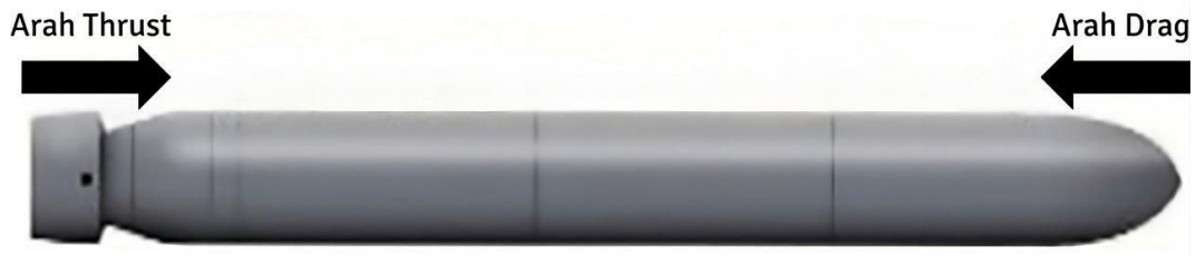
Gambar 2.2 Ilustrasi arah gaya hambat terhadap arah gerakan UUV
