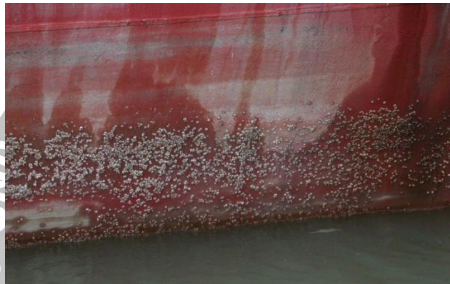
Gambar 2. 2 Biofouling pada Lambung Kapal
